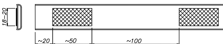
Рис. 16 Наклеивание двухсторонней ленты на декоративную планку
